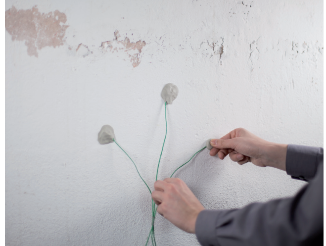
Зонд теплопровідності визначає не тільки середню у 3-х точках температуру стіни, але й температуру повітря в приміщенні.
