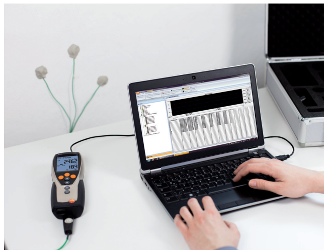
За процесом вимірювань коефіцієнта теплопровідності можна стежити в реальному часі за допомогою ПЗ testo ComSoft.
