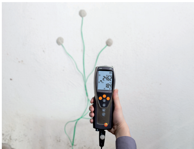
Прилад testo 635-2 розраховує коефіцієнт теплопровідності одночасно вимірюючи 5 значень температури.
