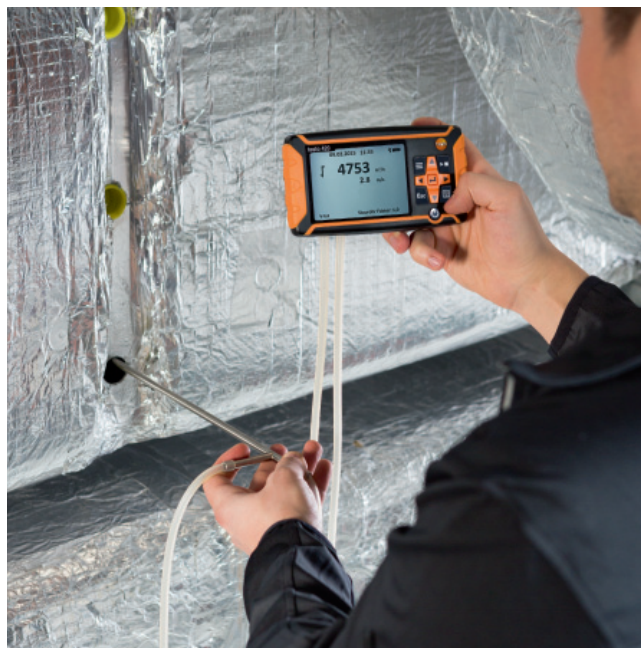
Прилад можна від'єднати від воронки та вимірювати швидкість за допомогою трубки Піто (додаткова опція).
