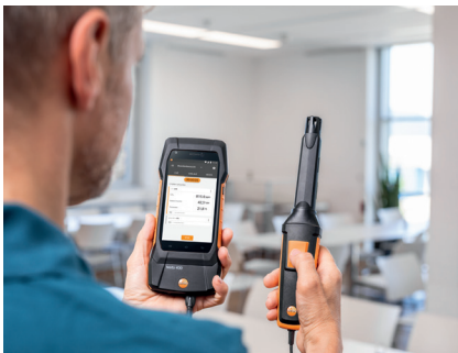
Рис. 1. Вимірювання температури та вологості навколишнього повітря за допомогою приладу testo 400 IAQ.
